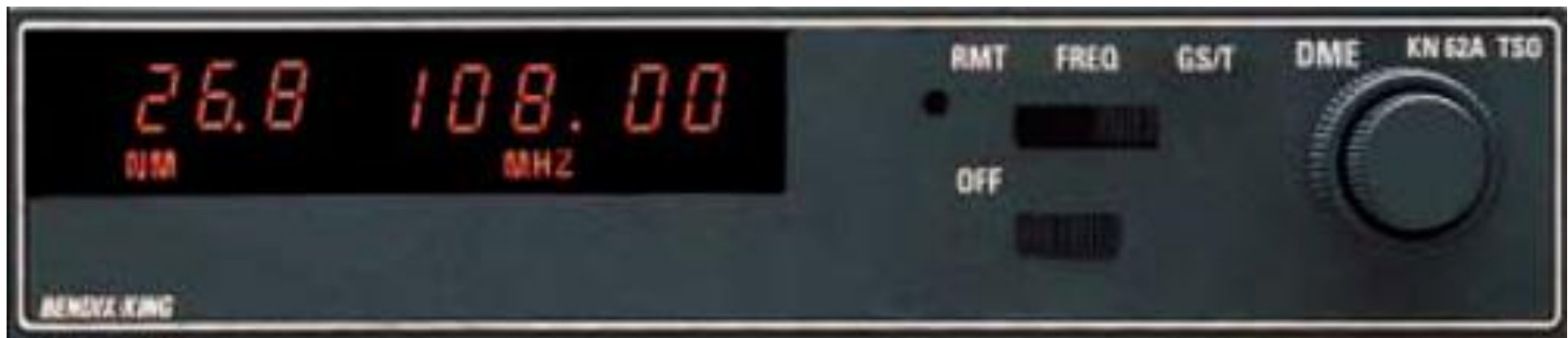
Fig.12.25 – Componentes do DME a bordo do avião: antena e instrumento no painel.
