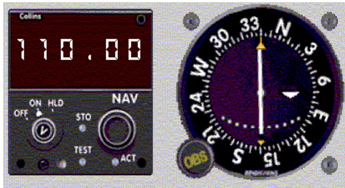
Fig. 12.14 - O equipamento VOR do avião.
