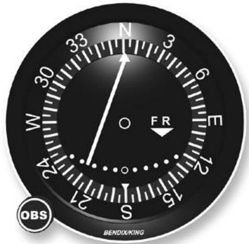
Fig. 12.17 – Dois tipos principais de CDI.
