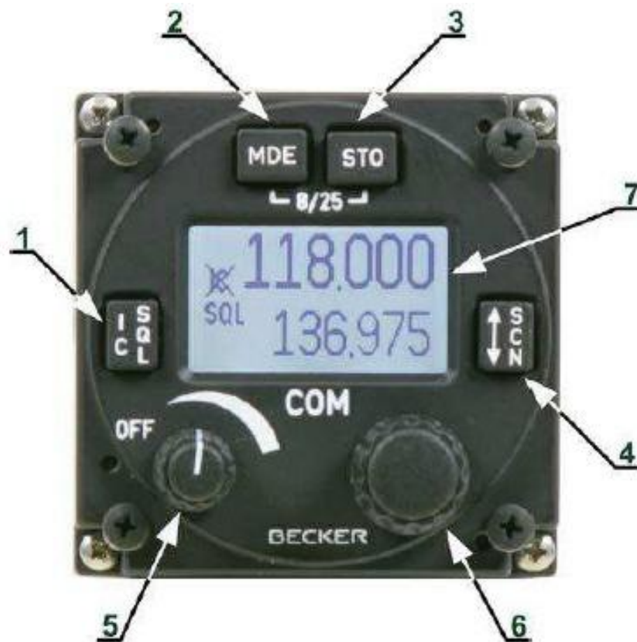
Fig. 12.12 – O rádio a bordo do avião serve como o transmissor para VDF.
