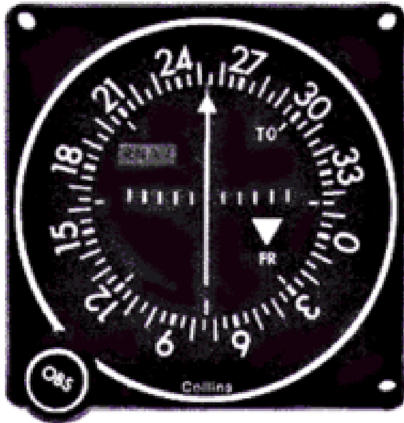
Fig. 12.17 – Dois tipos principais de CDI.
