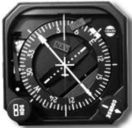
Fig. 12.24 - O HSI com o botão HDG para a escala do gyro; o botão COURSE é o OBS.
