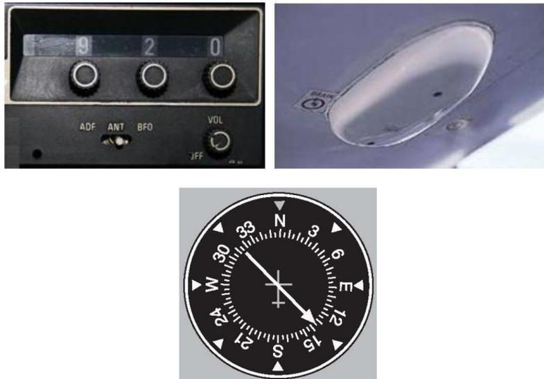
Fig. 12.1 - Os três componentes do ADF: o receptor (“ADF control panel”), as antenas (“combined loop and sense antenna”) e o instrumento que indica a direcção do NDB (“card and pointer”).
