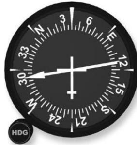
Fig. 12.10 – ADF ajustável manualmente.
